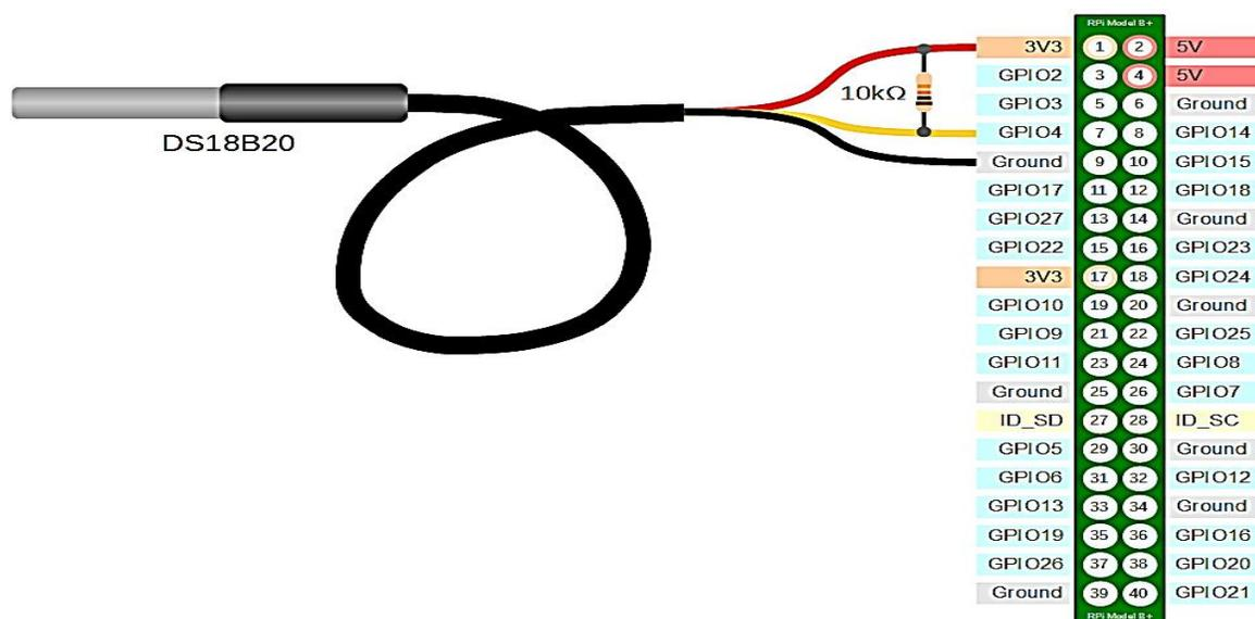
Figure 8. Circuit Diagram for the typical DS18B20 Temperature Probe(DS18B20, 2018)
